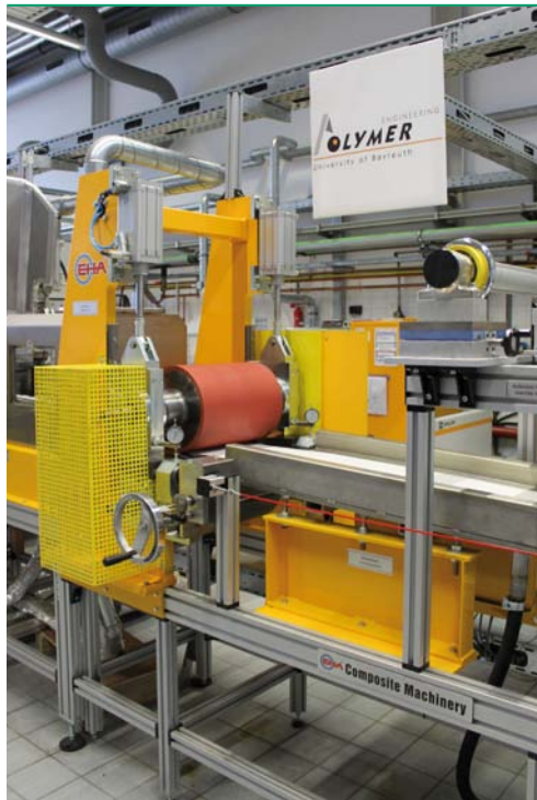
■ Abb. 2: Nachdem die Fasern mit Polymerharz imprägniert sind, werden die Prepregs gekühlt und aufgerollt (Foto: Christian Wißler).
